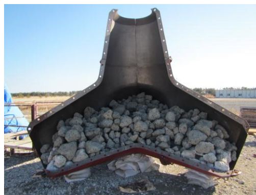
(a) がら投入状況
