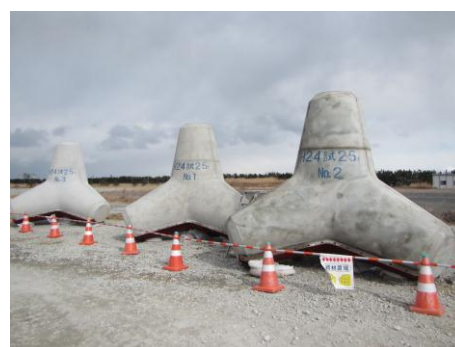
写真-9 震災がらと海水を用いて 製造した消波ブロック
