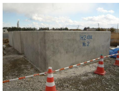
写真-10 震災がらと海水を用いて 製造した根固めブロック
