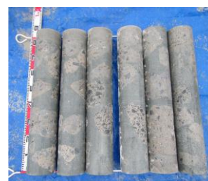
写真-8 ブロックより 採取したコア供試体
