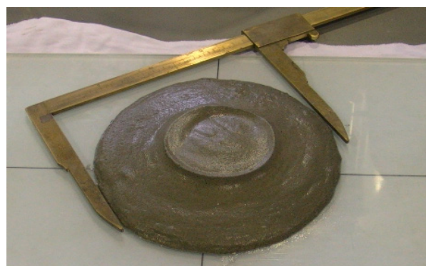
図-3 室内配合試験(フロー試験)
