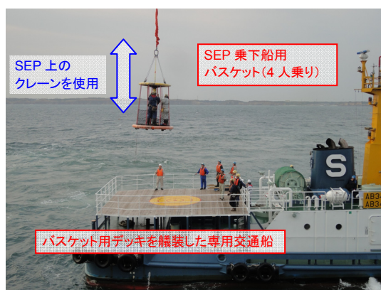
写真－7 バスケットを用いた作業員移動
