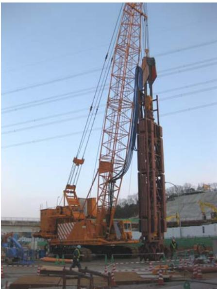
写真-1 ハイドロフレーズ掘削機
