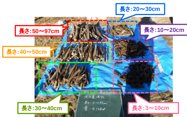
写真 7 投入した塵芥(沈木)
