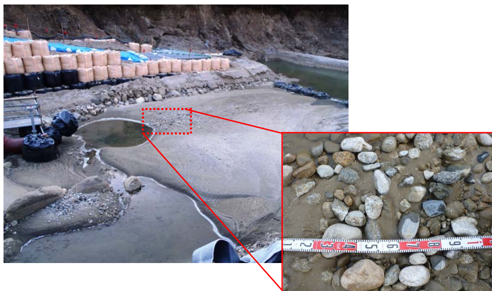
写真 4 沈砂池に排出された礫の状況(ケース②)
