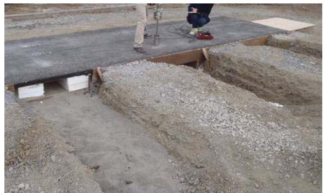
写真-2 模擬空洞を設置した試験舗装
