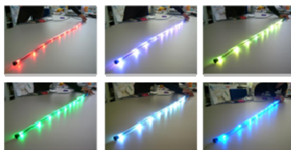
写真-1 光る変位計発光状況
