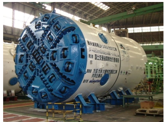
写真-1 泥水加圧式岩盤シールド
