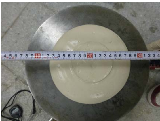
写真 3-6 フロー試験状況 (155mm) (打撃時・練混ぜ直後)
