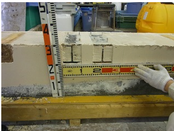
写真 3-11 H型鋼充填確認状況
