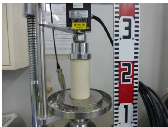
写真 3-8 圧縮試験状況
