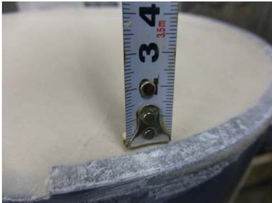
写真 3-15 収縮量測定状況
