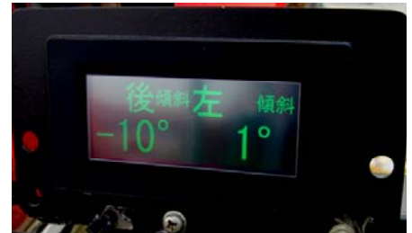
写真-4 傾斜測定器による測定
