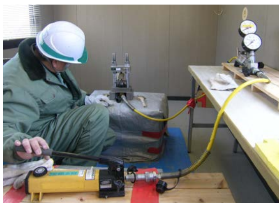
写真－1 点載荷試験状況
