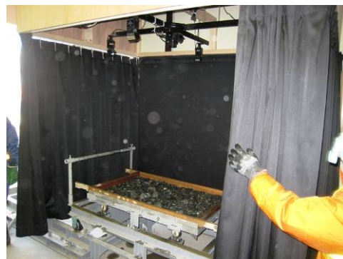
写真-13 “デジカメ法”による CSG 材粒度測定状況
