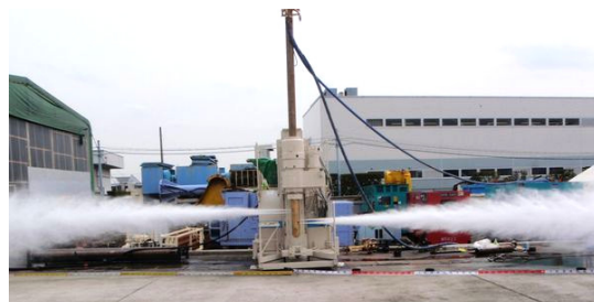
図-1 マルチジェット工法
