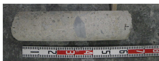
写真-6 コアの充填状況(ケース 3)
