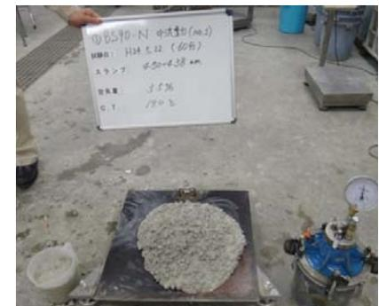
写真-3 フローコンクリート性状確認 (60 分後)
