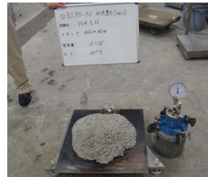
写真-2 フローコンクリート性状確認 (0 分後)
