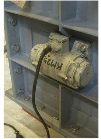
写真-7 型枠バイブレータ
