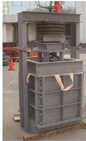
写真-6 盛土用ブロック製造装置
