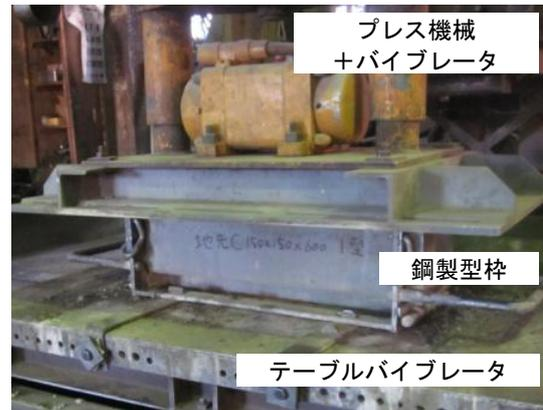
写真-3 コンクリート二次製品の製造状況
