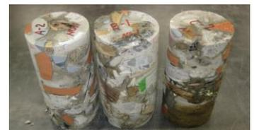
写真-9 一軸圧縮試験供試体
