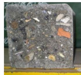
写真-5 曲げ試験後の破壊面
