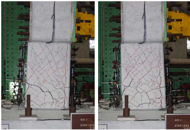
6 \delta y -6 \delta y 写真-6 試験体破壊状況 (No. 1)
