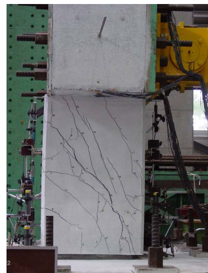
写真-5 試験体破壊状況 (No. 2)
