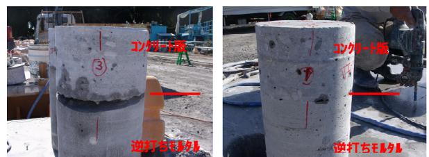
写真 - 3 接合面を含むコア抜き供試体
