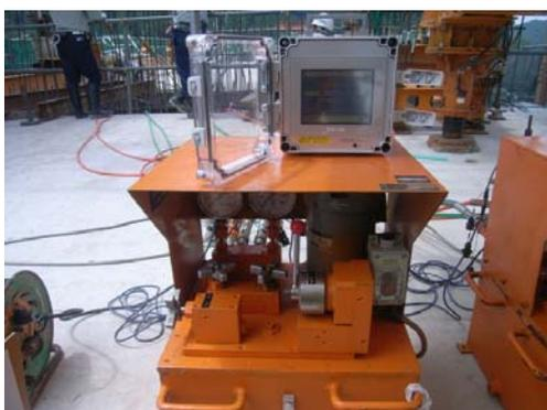
写真-4 水平変位調整用ポンプ
