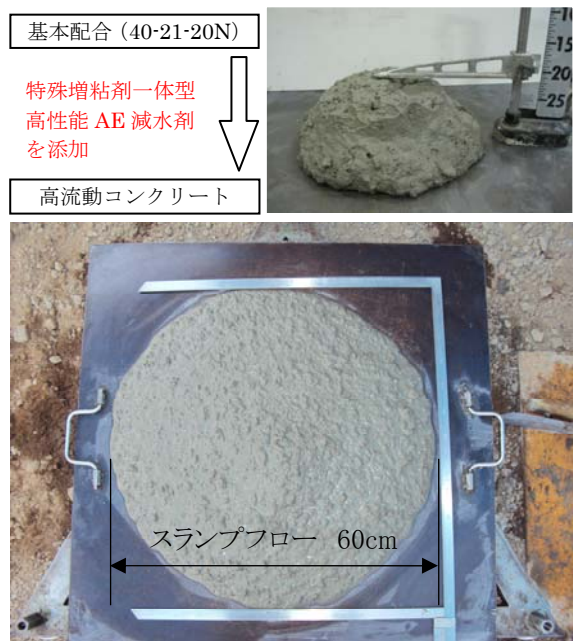
写真-1 特殊増粘剤系高流動コンクリート
