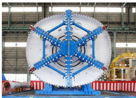
図2 EX-MAC工法の シールド掘進機
