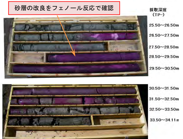
写真-2 コアボーリング調査結果
