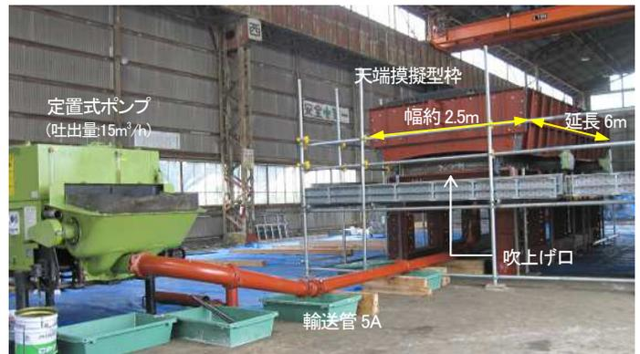
写真-1 天端模擬型枠の外観
