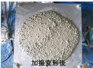
写真-12 加振変形試験
