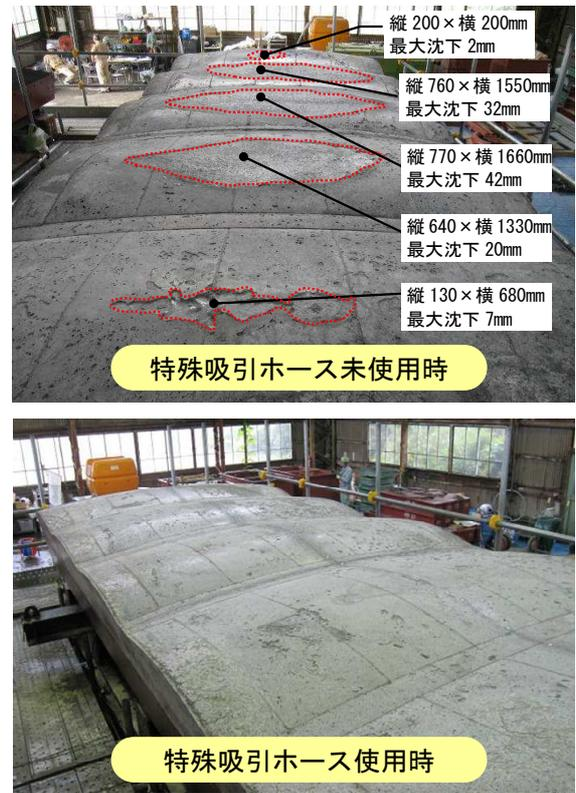
写真—16 覆工背面の仕上がり状況
