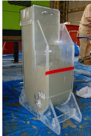
写真-13 U型充填性試験
