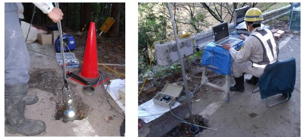
写真-8 (左) CCDカメラ挿入状況と写真-9 (右) モニタリングの状況
