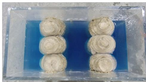
写真-2 水中打設状況(上面)
