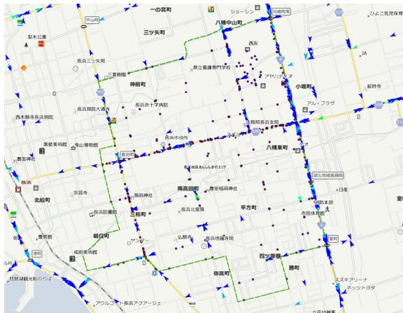
図-10 長浜地区における急ブレーキ発生箇所
