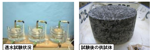
図-3 透水試験状況
