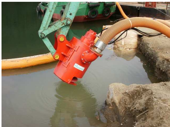
写真-6 スクリーパー破碎機
