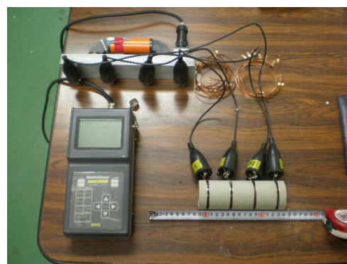
写真-1 改良地盤の比抵抗測定状況
