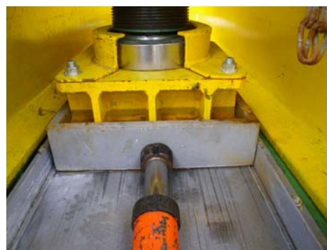
写真-3 メインジャッキ回転装置
