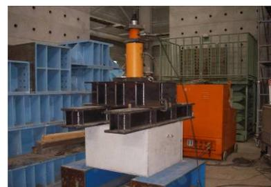
写真-6 引抜実験状況
