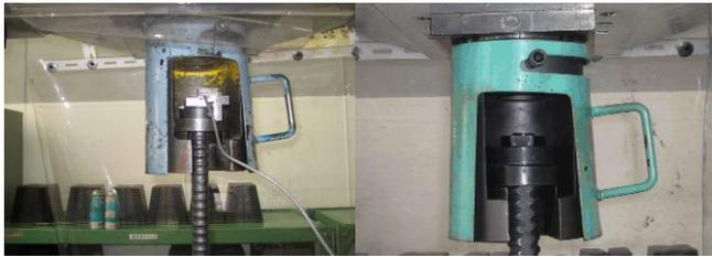
写真-2 定着具の引張試験状況
