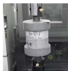
写真-2 直接引張試験状況
