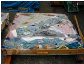
(3) 床版給水状態
