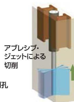
図-4 アブレシブ・ウォールカット工法施工手順
