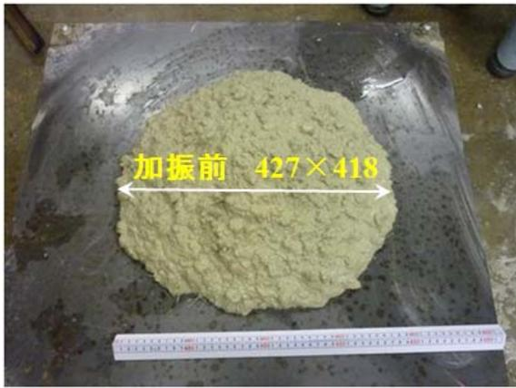
写真-1 加振前のスランプフロー
