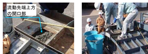
写真-5 流動先端の開口部と試料採取状況
