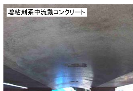
(a) 表面側（下面）：覆工の仕上がり面に相当
