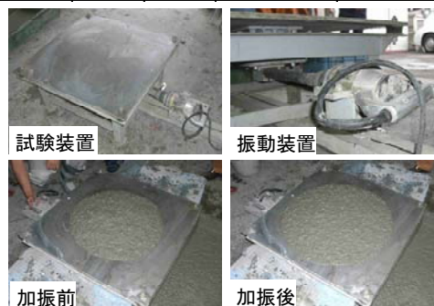
写真-1 加振・変形試験の概要
