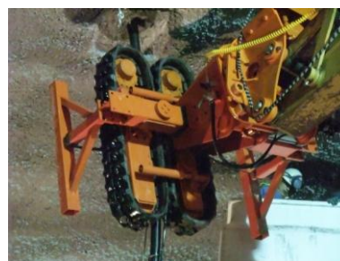
写真-5 アンカー挿入装置
