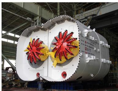
写真-1 アポロカッター工法のシールド機
