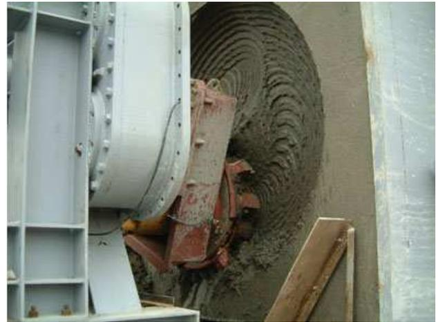
写真-4 硬質地盤掘削性能確認実験状況
