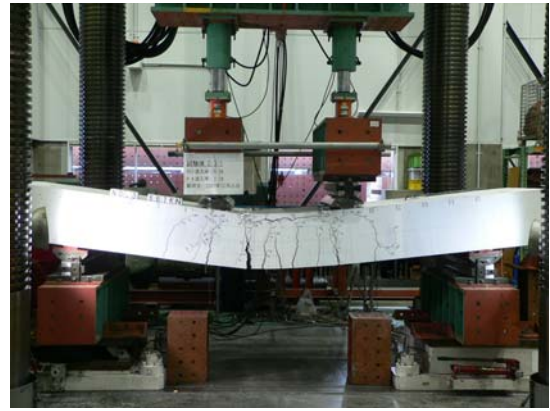
写真-4 平板実物大 曲げ載荷試験状況
