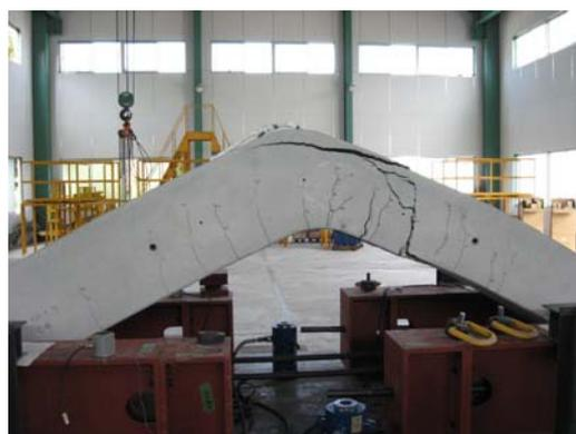
写真-2 破壊状況 (Case2 単調载荷正曲げ)
