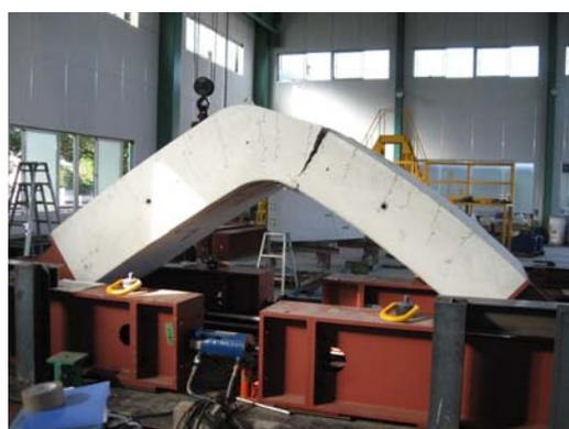
写真-3 破壊状況 (Case3 単調载荷負曲げ)
