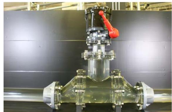
図-5 使用モデル配管の空気弁 (Case 1)
