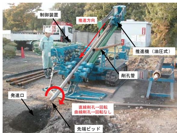
図-1 専用削孔機
