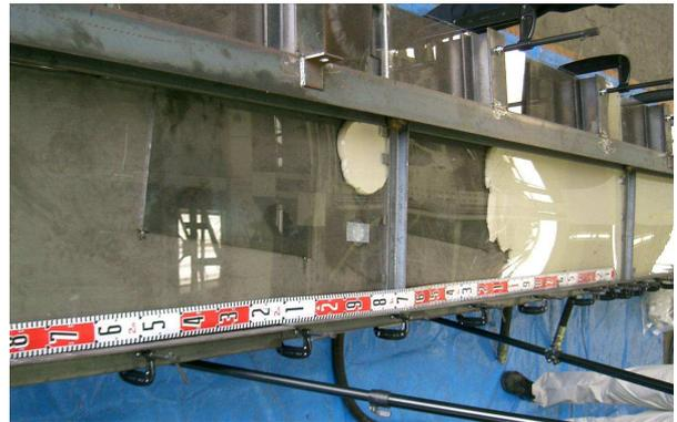
写真-7 ボイドキーパーS充填実験状況
