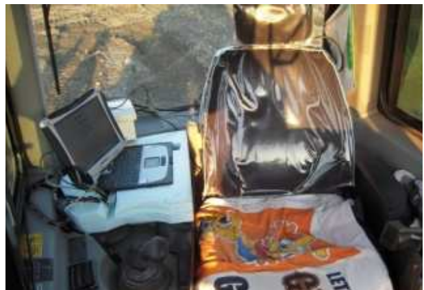
写真-4 車載PCの設置状況
