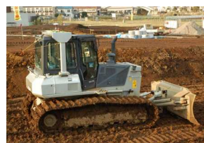
締固め重機（ブルドーザ）
