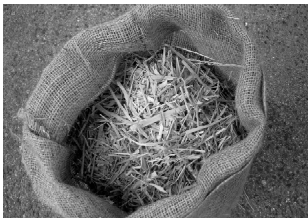
写真-7 古畳を粉碎して麻の袋に詰めた押伏せマット
