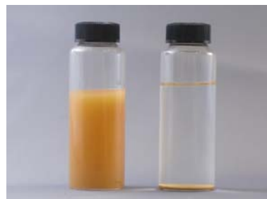
写真-2 キトサン凝集剤の凝集沈降性 (左：処理前，右：処理後)
