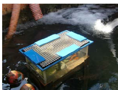
写真-4 金魚による処理水のモニタリング
