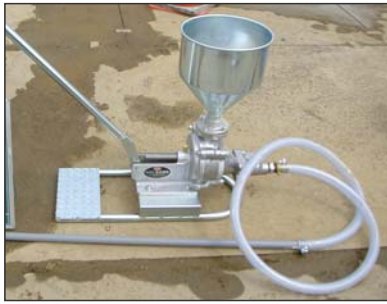
写真-6 手押しポンプによるモルタル充てん
