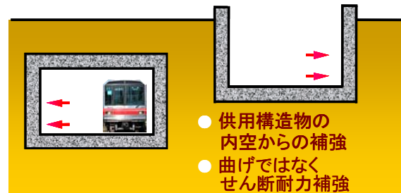
図-1 地下・半地下構造物の耐震補強
