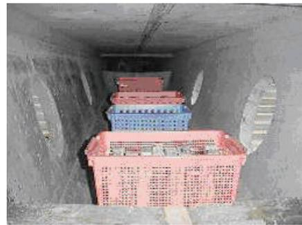
写真-11 桁内に収納された多量の暴露供試体
