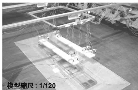
写真-4 沈設作業船と沈設手順の確認実験
