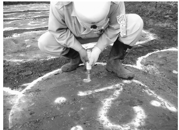
写真-5 針貫入試験の試験状況
