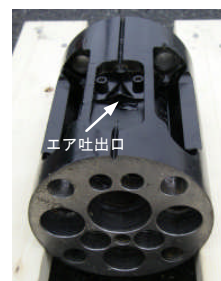
写真-23 バックエア管
