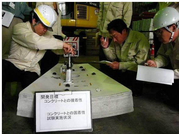
写真2 セグメントの固着性試験状況
