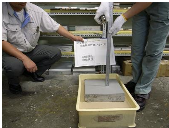
写真4 耐衝撃性試験
