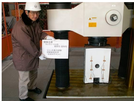
写真6 合成セグメント載荷状況
