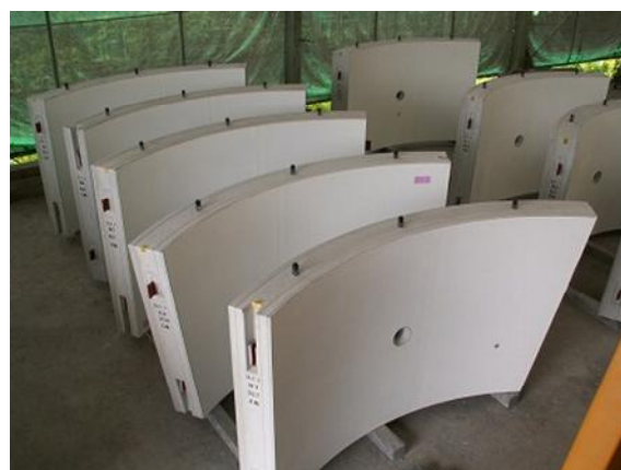
写真10 C Rライニングセグメント製作完了
