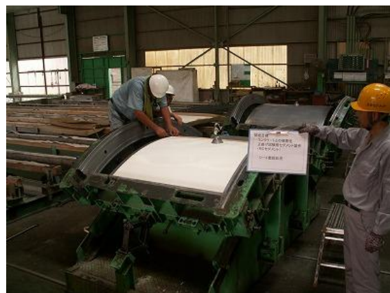
写真9 シート敷設状況
