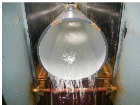
写真8 試験状況（流量 40m³/h, 勾配 3‰のケース）
