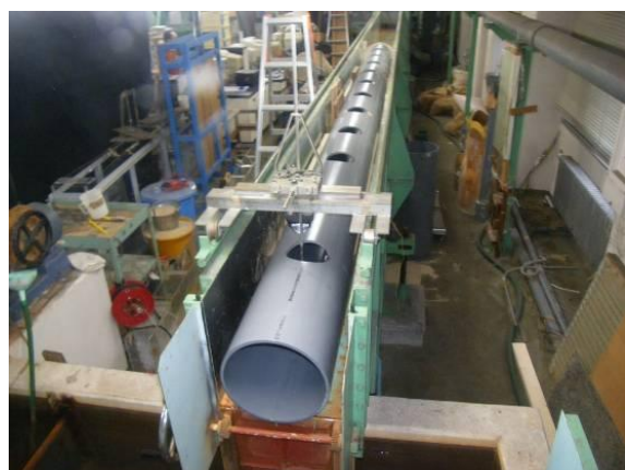
写真7 粗度係数測定装置
