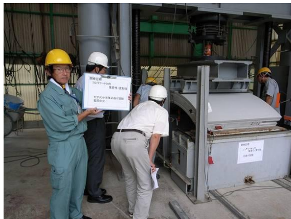
写真5 単体正曲げ試験状況
